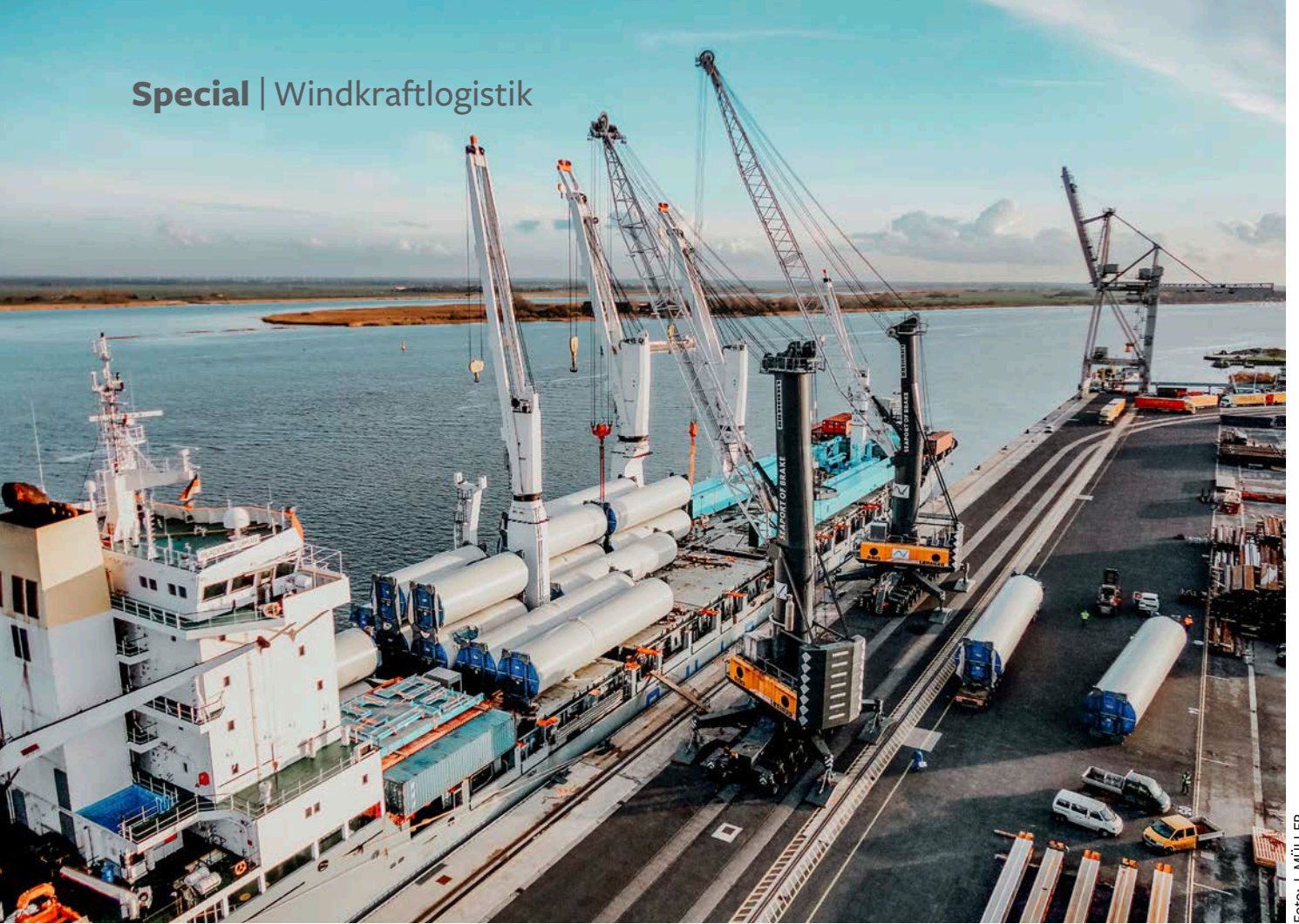
Niedersachsenkai Brake - Verladung von Turmteilen
